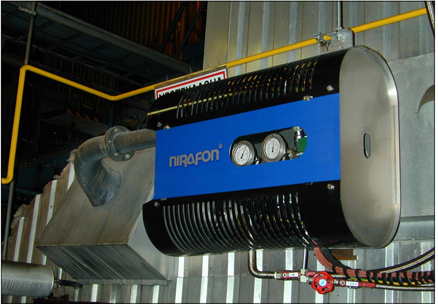
Новый звуковой очиститель ОЗУН сейчас установлен в дымоход на заводе Флутинг компании Стура Энсо в Хейнола.
